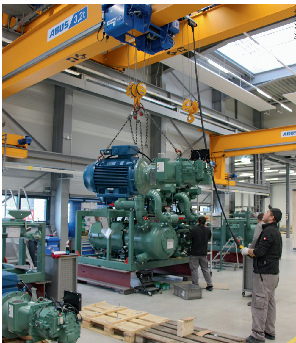
Zwei Abus-Einträgerwandlaufkrane EWL 3,2 Tonnen unterstützen die Monteure bei der Endfertigung der Bitzer-ACP. Hier wird ein schwerer Elektromotor zu seinem Bestimmungsort transportiert.
