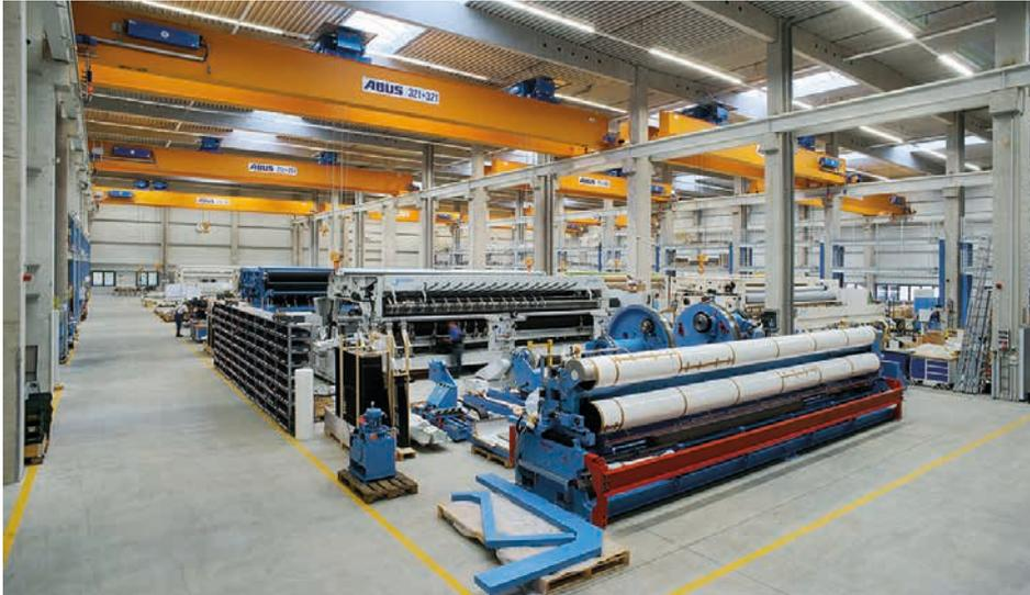
◀ Gesteuert werden die Krane über eine Abus-Funkfernsteuerung. Sie ermöglicht dem Kranführer die Kranbedienung von einem sicheren Standort aus
