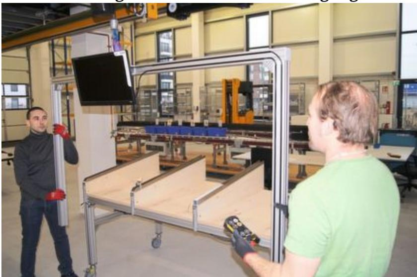
Die Hängebahnanlage unterhalb der Stahlbühne im Versuchsfeld bietet Unterstützung bei leichten Handling-Aufgaben, hier zum Beispiel bei der Montage eines Kommissioniertisches. (Bild: Abus Kransysteme)
