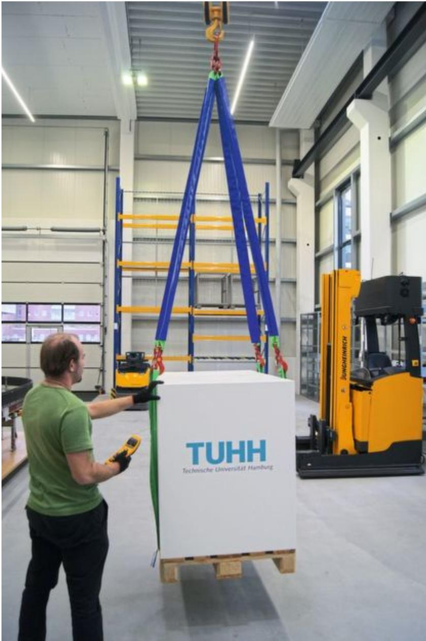
Durch mathematische Berechnungen anhand von Hubhöhe, Fahrgeschwindigkeiten und Anschlagmittellänge berechnet Abucontrol die erwartete Pendelbewegung und steuert aktiv gegen. (Bild: Abus Kransysteme)
