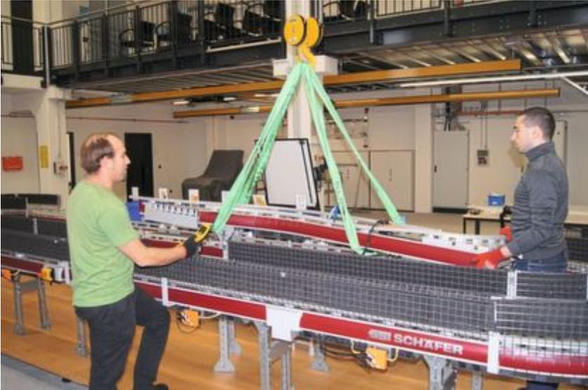
Das zielgenaue Positionieren der Anlagenelemente wird durch die Funksteuerung Aburemote deutlich vereinfacht, da die Kranbediener vollständige Bewegungsfreiheit haben. (Bild: Abus Kransysteme)
