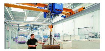
Herausragend seien dabei vor allem die für einen Serienlaufkran vollkommen neuartigen Features, teilt Abus mit. Highlight ist die Pendeldämpfung, die ungewollte Bewegungen der Last verhindert. Das System basiert auf mathematischen Berechnungen und den aktuellen Messwerten der Geschwindigkeit und Hakenhöhe. Kran und Katze werden so abgebremst und beschleunigt, dass die Fahrbewegung dem trägheitsbasierten Lastpendeln entgegenwirkt und die Last so nahezu ohne Eigenbewegung am Haken hängt.
