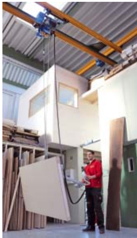
/ Durch den um 90 Grad schwenkbaren Vakuumheber können auch stehend gelagerte Teile, wie dieser Türrohling, mit dem Kran entnommen werden.
