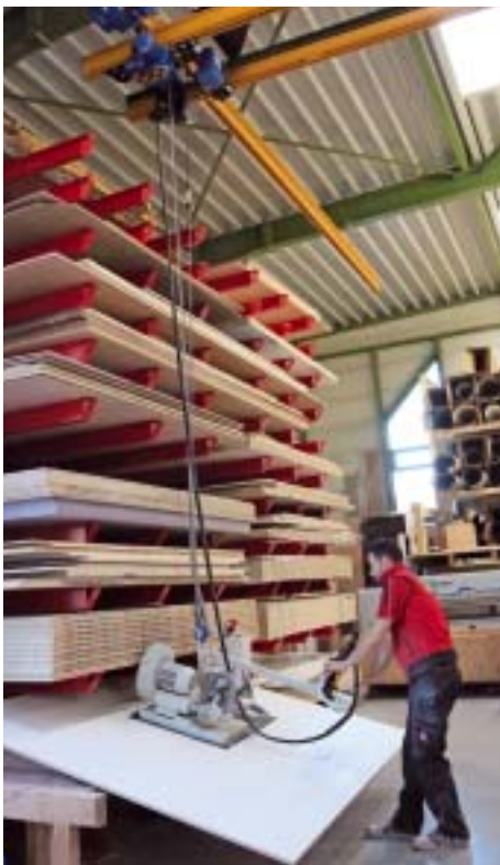
/ Das Plattenlager an der Wand ist problemlos erreichbar. Wie das funktioniert, sieht man oben im Bild: Die Kranträger ragen seitlich über die Kranbahn hinaus.
