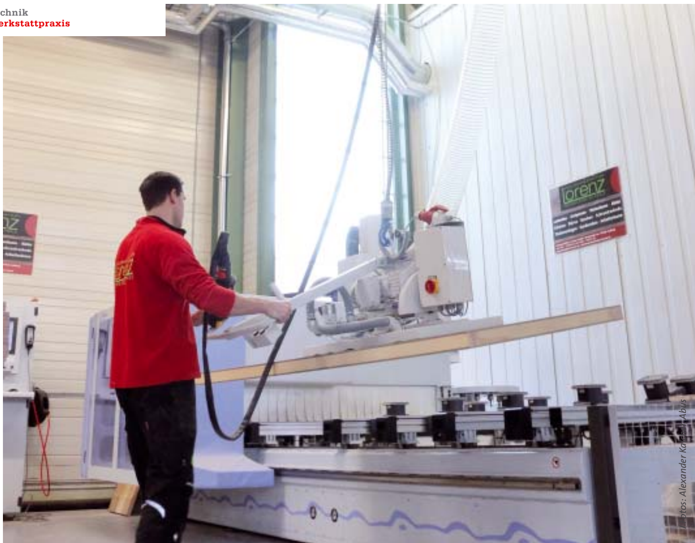
/ Ergonomische Arbeitsbedingungen: Mit Kran und Vakuumheber landet selbst das schwerste Türblatt ganz einfach auf der Maschine.
