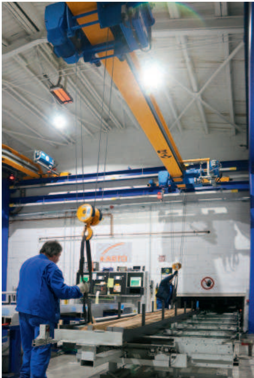
Das Amco-Hochregallager fasst 3000 Kassetten für Langgut, das mit zwei Abus-Kranen kommissionsgerecht entnommen wird.
