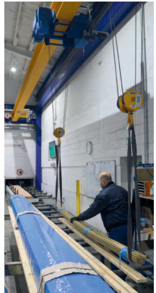
In Katzfahrrichtung wird das Langgut von der Ausgabestelle zur Folieranlage transportiert, wo die kommissionierten Stangen und Profile verpackt werden.
