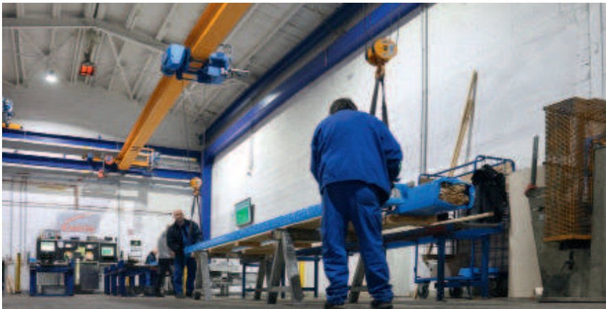
Die hohe Katzfahrgeschwindigkeit des 16 m langen Krans trägt dem schnellen Arbeitstakt bei Amco Rechnung.
