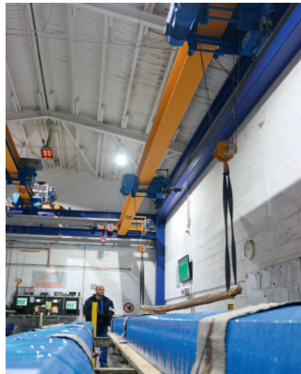
Obwohl der linke Laufkran über seinem Ablagetisch in der Hallenmitte steht, hat der rechte Kran noch einen ausreichenden Verfahrweg.
