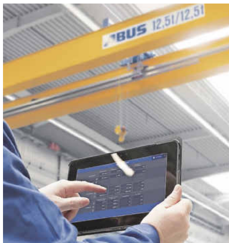
Der Bediener loggt sich vom Boden aus drahtlos per WLAN am Kran ein und kann auf dem Bildschirm seine individuellen Einstellungen vornehmen.
