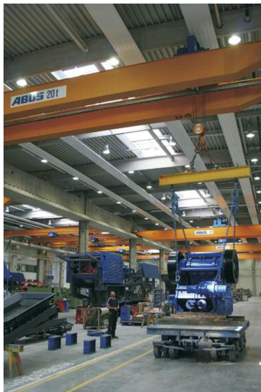
Endmontagebereich: Mit einem 20-Tonnen-Zweiträger-Laufkran mit Traverse wird ein Brechergehäuse angehoben
