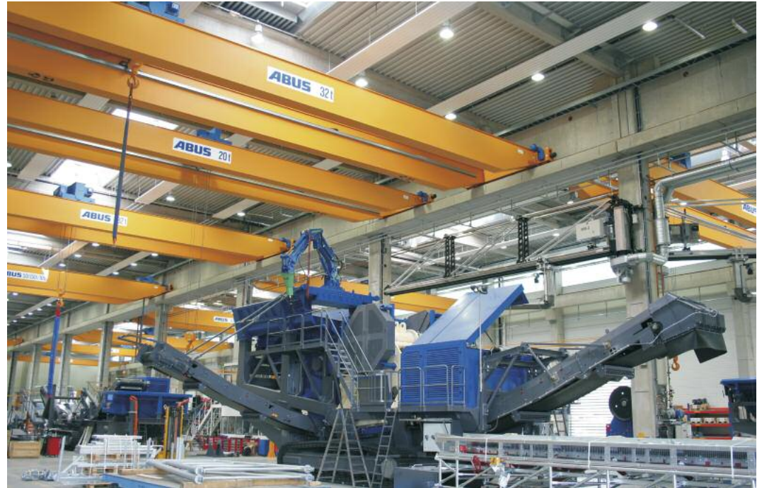
Im gesamten, neu errichteten Kleemann-Werk in Göppingen werden Abus-Laufkrane eingesetzt, um solche mobilen Brecher-Anlagen präzise zu montieren
