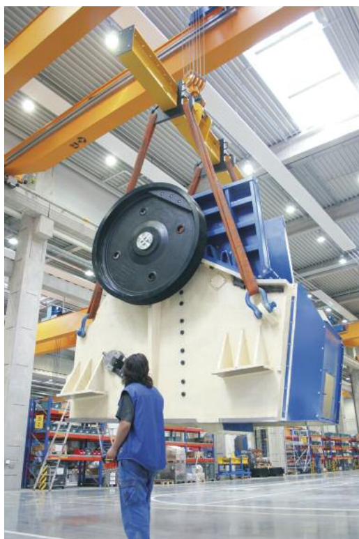
Bis zu 50 Tonnen kann ein einzelnes Brechergehäuse wiegen. Behutsam wird es mit einem Zweiträger-Laufkran zum Fahrzeugrahmen transportiert
