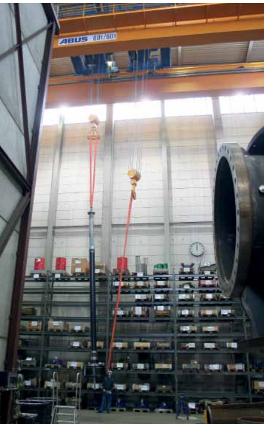
01 Durch unterschiedliches Heben und aufeinander zufahren der Katzen werden die Pumpenbauteile gewendet. Die Bedienung der Krananlage geschieht per Funkfernsteuerung
