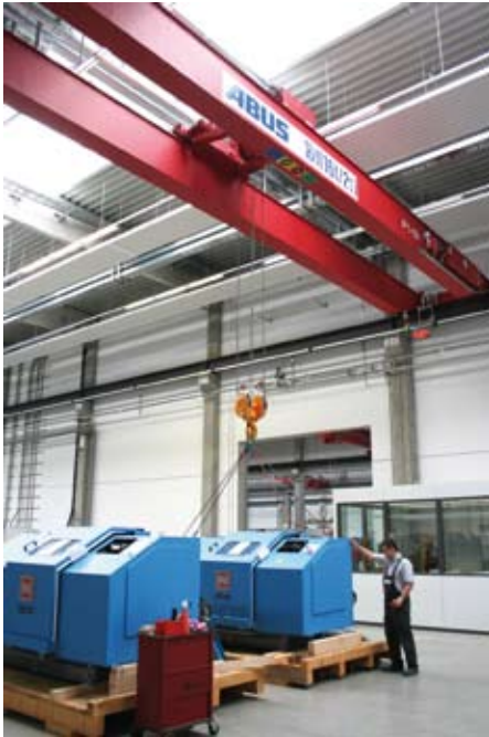
Bild 1: Über eine Großlastanzeige am Hauptträger lesen die Mitarbeiter das Gewicht der Komponenten ab
