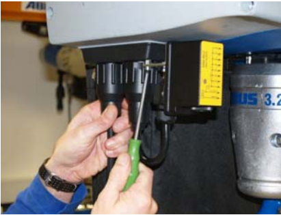
Bild 02: Der Empfänger ist in wenigen Minuten montiert. Er wird lediglich mit dem beiliegenden Winkel am ABUCompact-Kettenzug befestigt.
