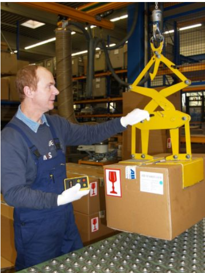
Bild 03: Immer, wenn der Bediener flexibel und ortsunabhängig mit dem Kettenzug arbeiten will, bietet sich der Einsatz der Mini-RC an.
