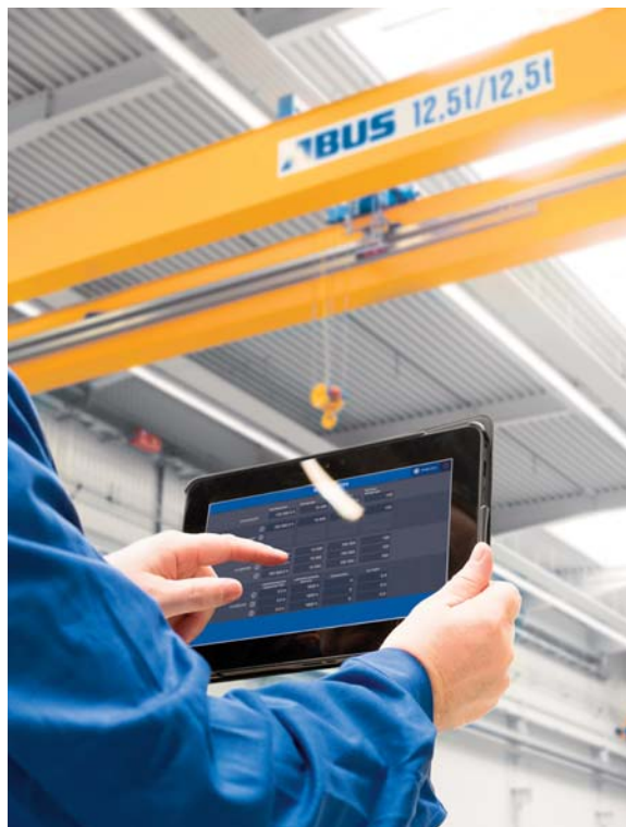
Mittels Webbrowser kann über Abus-Kran-OS drahtlos auf Abucontrol zugegriffen werden
