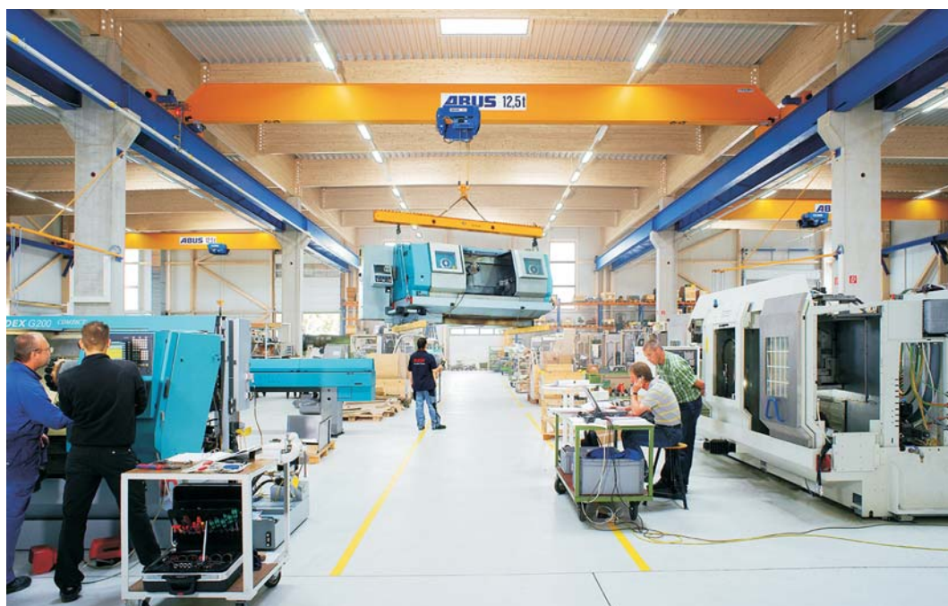
Für Kranführer, die nur gelegentlich Lasten mit einem Laufkran bewegen, bietet Abucontrol zusätzliche Sicherheit. So wird durch die Pendeldämpfung das Lastpendeln verhindert
