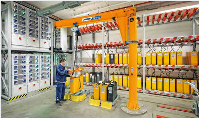
Rundum beweglich ABUS Säulenschwenkkrane bis 6,3 t
