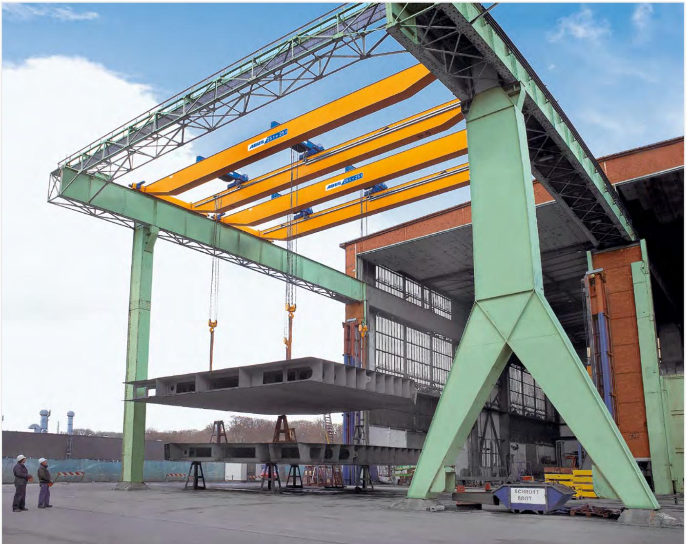
Für diese besondere Logistikaufgabe bietet die ABUS ABUControl-Tandemsteuerung die sicherste Lösung. Sie ermöglicht es, zwei Krane mittels einer Funksteuerung gleichzeitig zu bewegen. Der Bediener kann seinen optimalen Standort nach den jeweiligen Betriebsbedingungen wählen.
