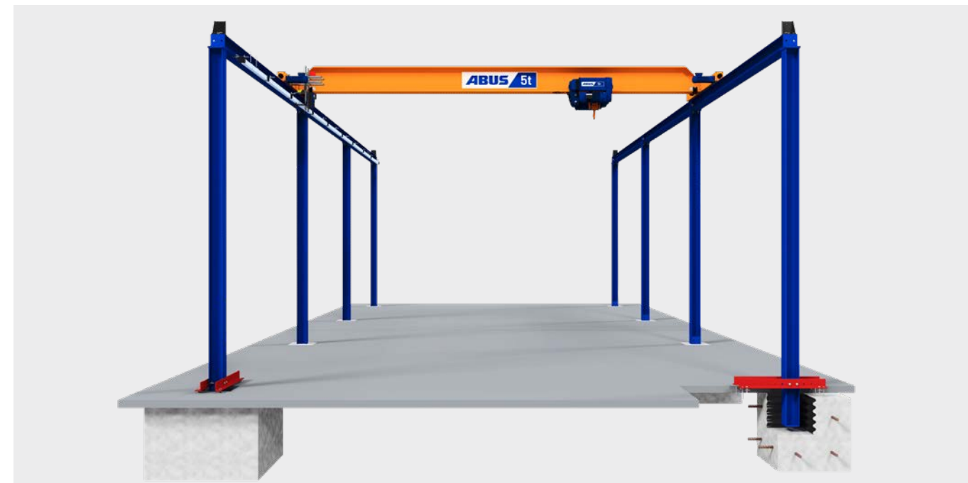
Kranbahn auf Einspannstützen in Köcherfundamenten
