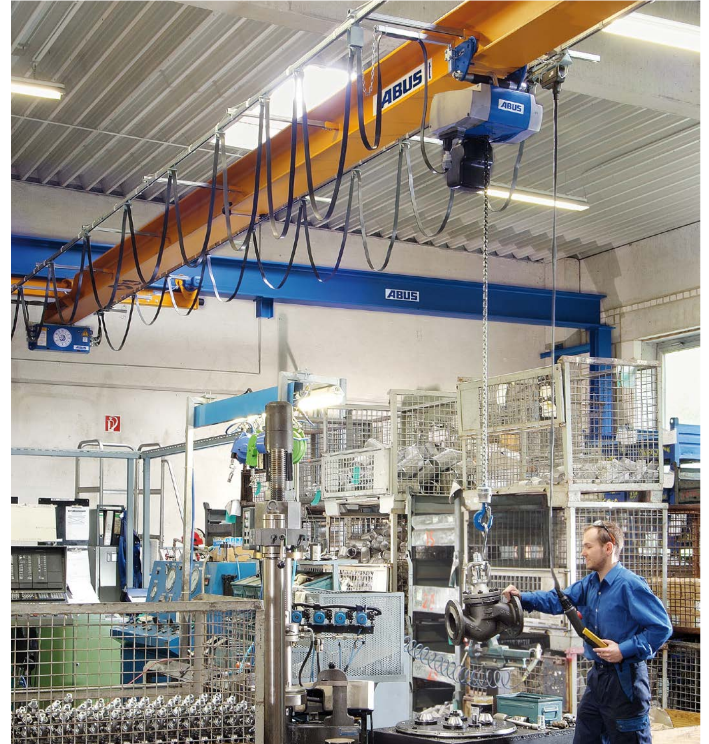
Kranbahn für Deckenlaufkrane auf Stützen
