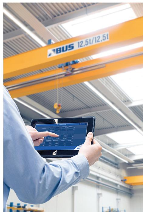
Mittels Webbrowser kann der Anwender auf die Steuerung zugreifen und alle Einstellungen vom Boden aus verändern. (Fotos: Abus)
