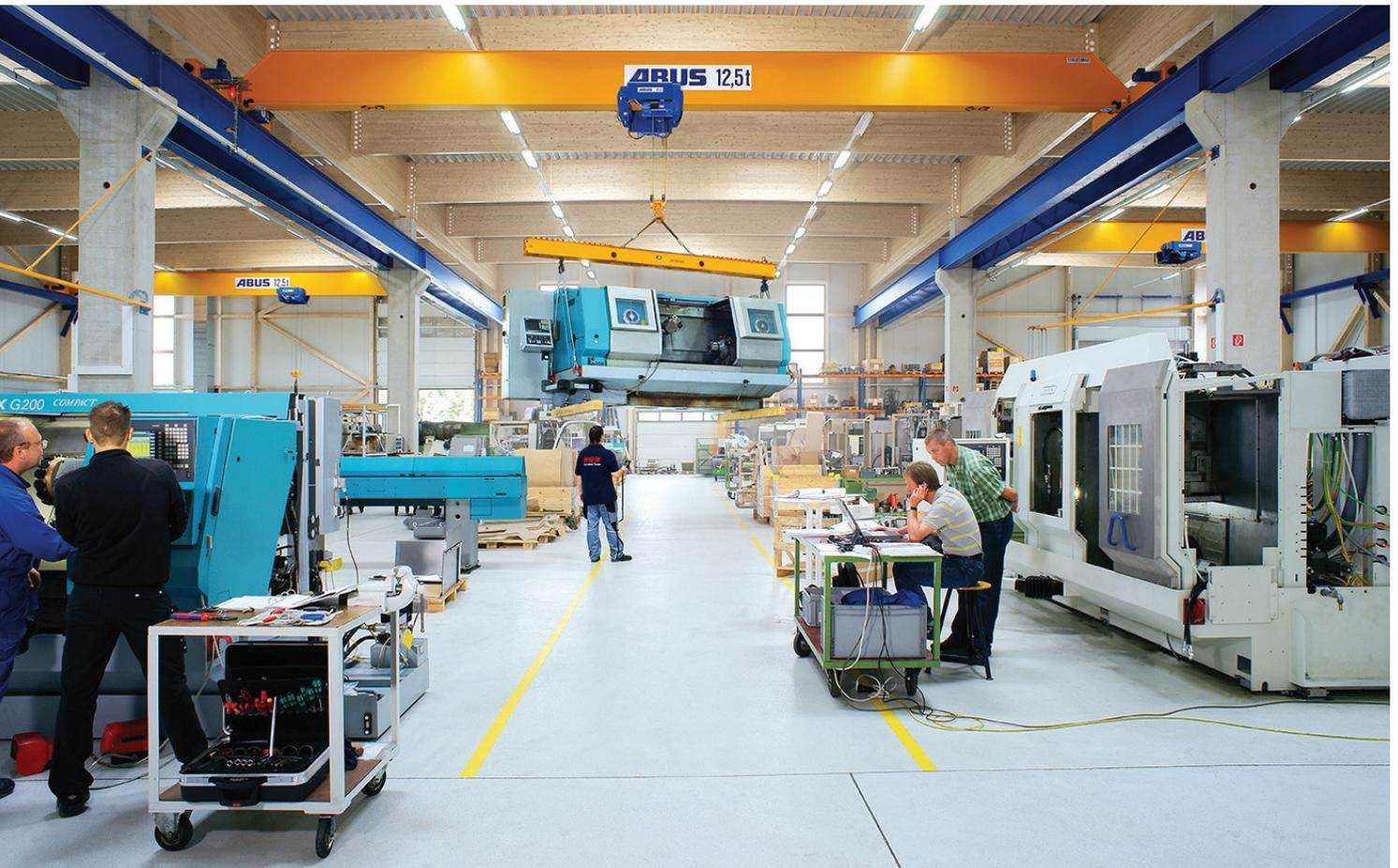
Besonders für Kranführer, die nur gelegentlich Lasten mit einem Laufkran bewegen, bietet die Abus-Steuerung Sicherheit durch Pendeldämpfung.
