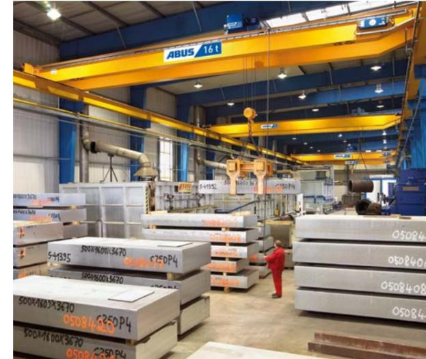
Zweischienenlaufkatzen der Bauart D auf Zweiträgerlaufkränen.
