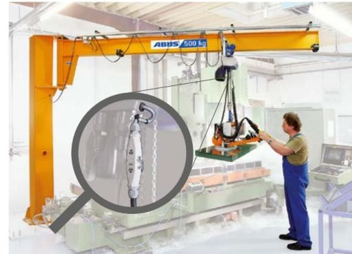
Schwenkkrane mit Vakuumgerät u. Stecker (Bild 13)
