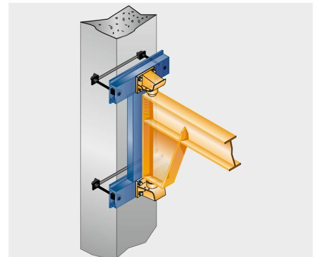
ABUS liefert die für die Stützenmaße ausgelegte Konsolenausführung mit dem erforderlichen Befestigungsmaterial und den Abrutschsicherungen.
