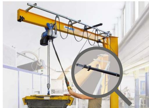
Schwenkansschlag Pufferstange (Bild 4)
