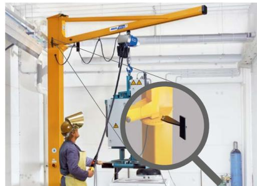
Schwenkansschläge verstellbar (Bild 5)
