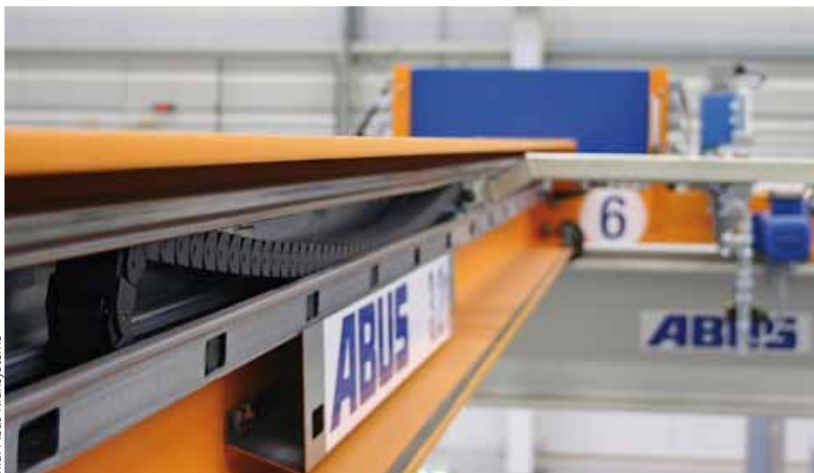
Bild 2: Seit über zehn Jahren verfahren auch Abus-Hängetaster mittels Energiekette. Vor allem bei kleinen Kranträgerhöhen macht sich der seitliche Anbauort positiv bemerkbar.
