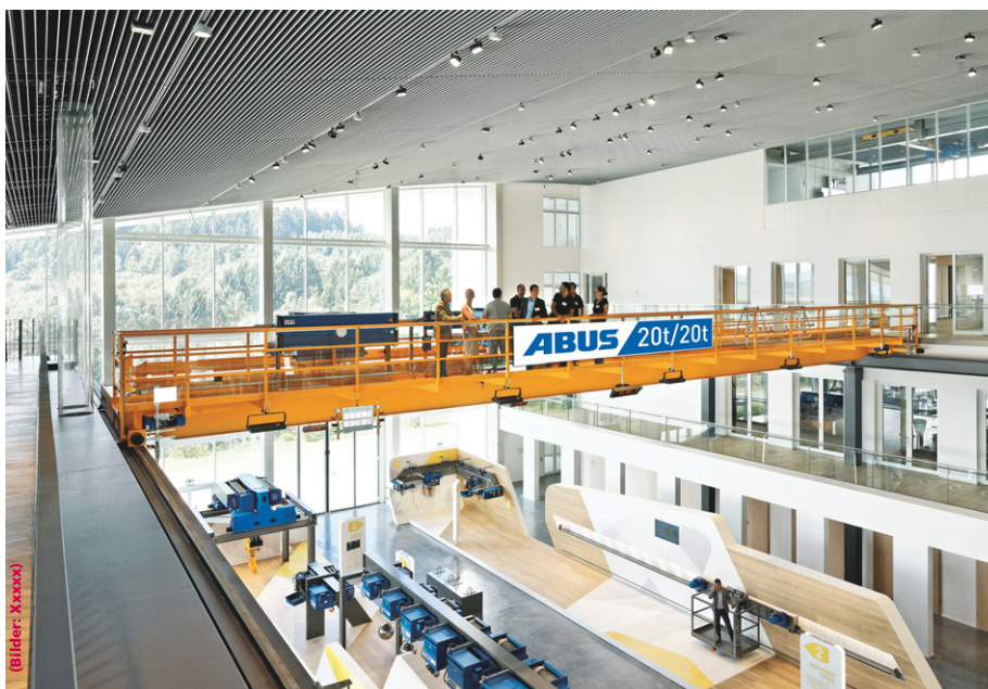
Highlight des Kranhauses ist der begehbare Zweiträgerlaufkran, auf dem die Gäste in 8 m Höhe mitfahren und das Fahrgefühl und -verhalten des Krans selbst erleben können.
